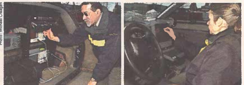
Photo: Michael Craigen L'agent de gestion du Spectre, Manuel Escobar, montre l'équipement électronique à l'arrière du véhicule mobile de surveillance qui est observé à distance par l'ordinateur de l'agent de gestion Gwen Arthurs, qui occupe le poste d'opérateur à l'avant du véhicule.
