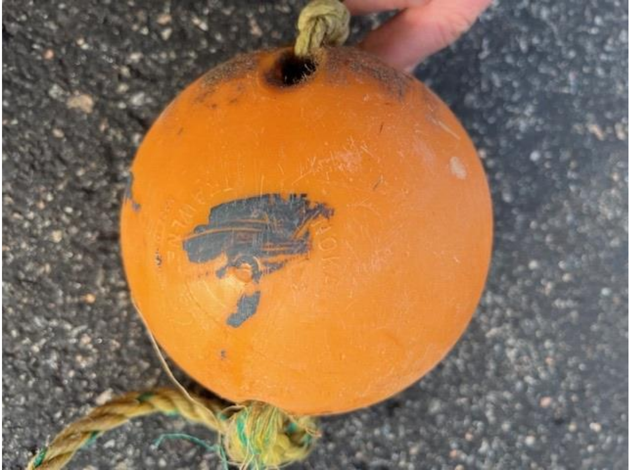
Fig. 3. Bouée sphérique orange (diamètre de 12,7 cm/5 po.) en plastique dur. Des cavités situées aux extrémités opposées de la bouée permettent de passer une corde de 0,95 cm (3/8 po.) afin de la fixer. Le nom et le pays du fabricant sont visibles (Nokalon, Danemark). La bouée présentait une fissure. Crédit photo : Ed Trippel, MPO.
