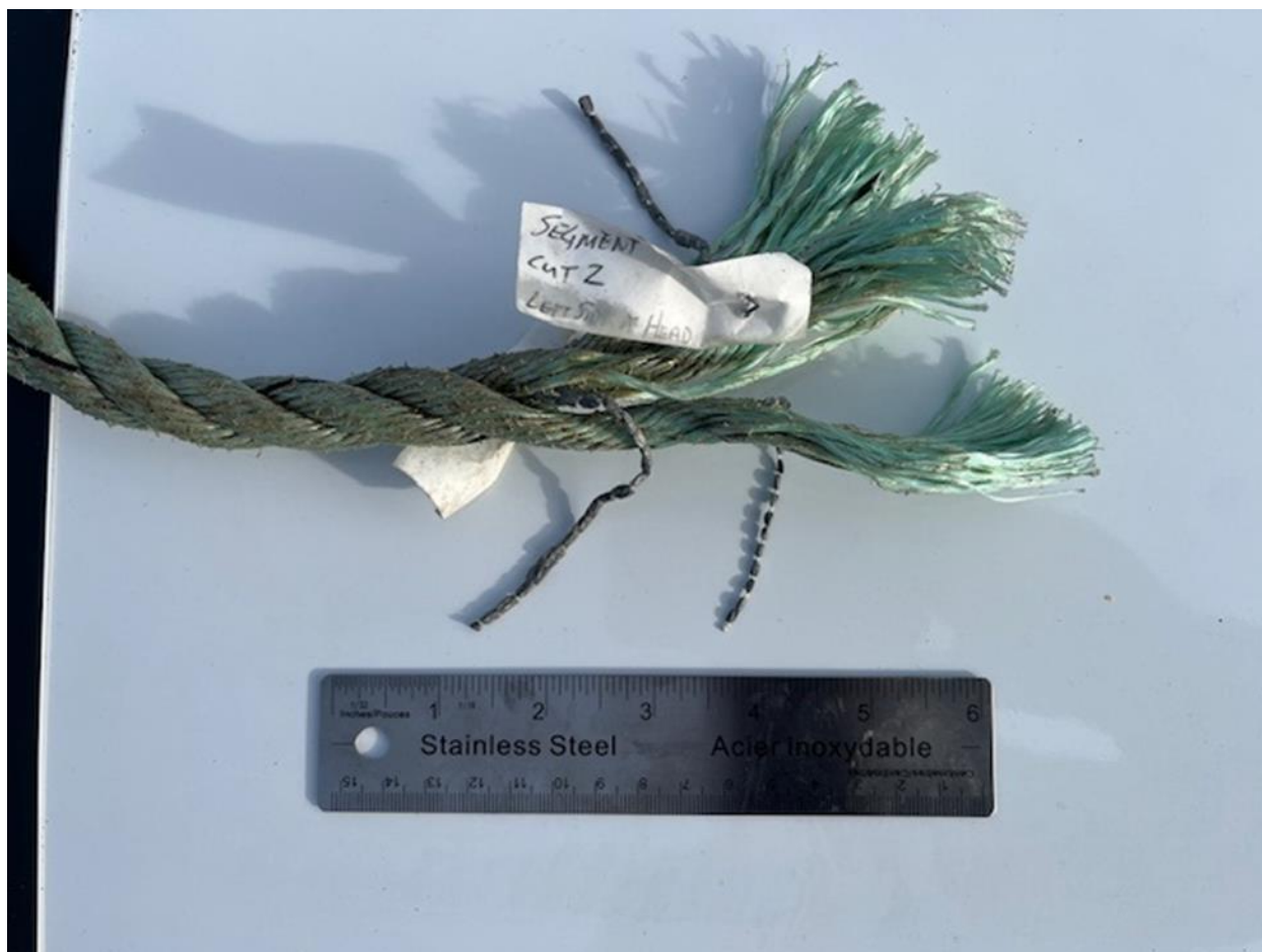
Fig. 7. Segment 2 : Coupe réalisée par l'équipe de démêlage sur une corde de 1,6 cm (5/8 po.). Les billes métalliques présentes dans chacun des trois brins sont visibles. Crédit photo : Ed Trippel, MPO.
