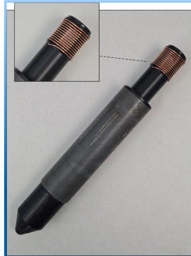
GT Figure 4: Protection en fil de cuivre sur l'enregistreur d'oxygène dissous pour réduire l'encrassement biologique. Crédit : J. Walker, MPO.
