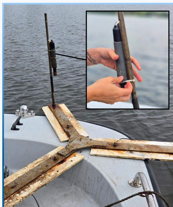
GT Figure 2: Enregistreur d'oxygène dissous fixé à un poteau rigide en tige d'armature monté sur un pied tripode, afin de maintenir l'équipement en position verticale dans la colonne d'eau et d'éviter qu'il ne s'enfonce dans les sédiments. Crédit: J. Walker, MPO.
