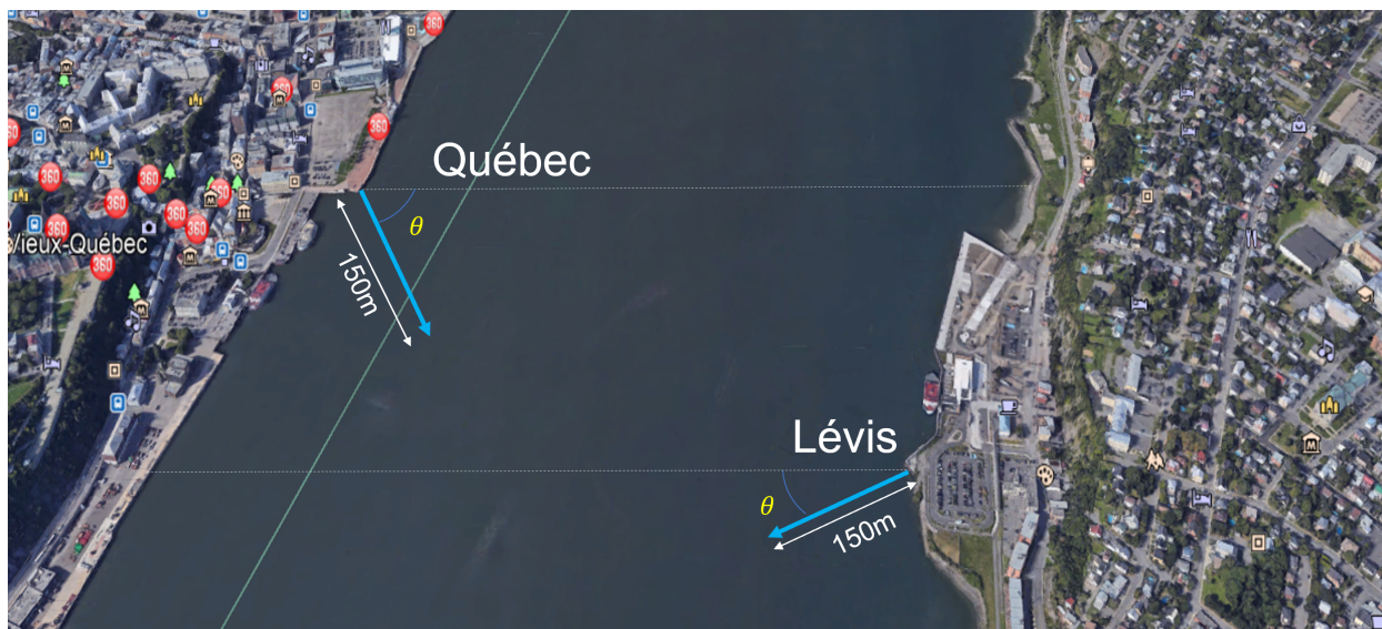
Figure 34. Carte de la position (début des deux flèches) et de la couverture (flèches bleues) des deux ADCP horizontaux déployés de chaque côté du Saint-Laurent, un au port de Québec et un au quai de Lévis.
