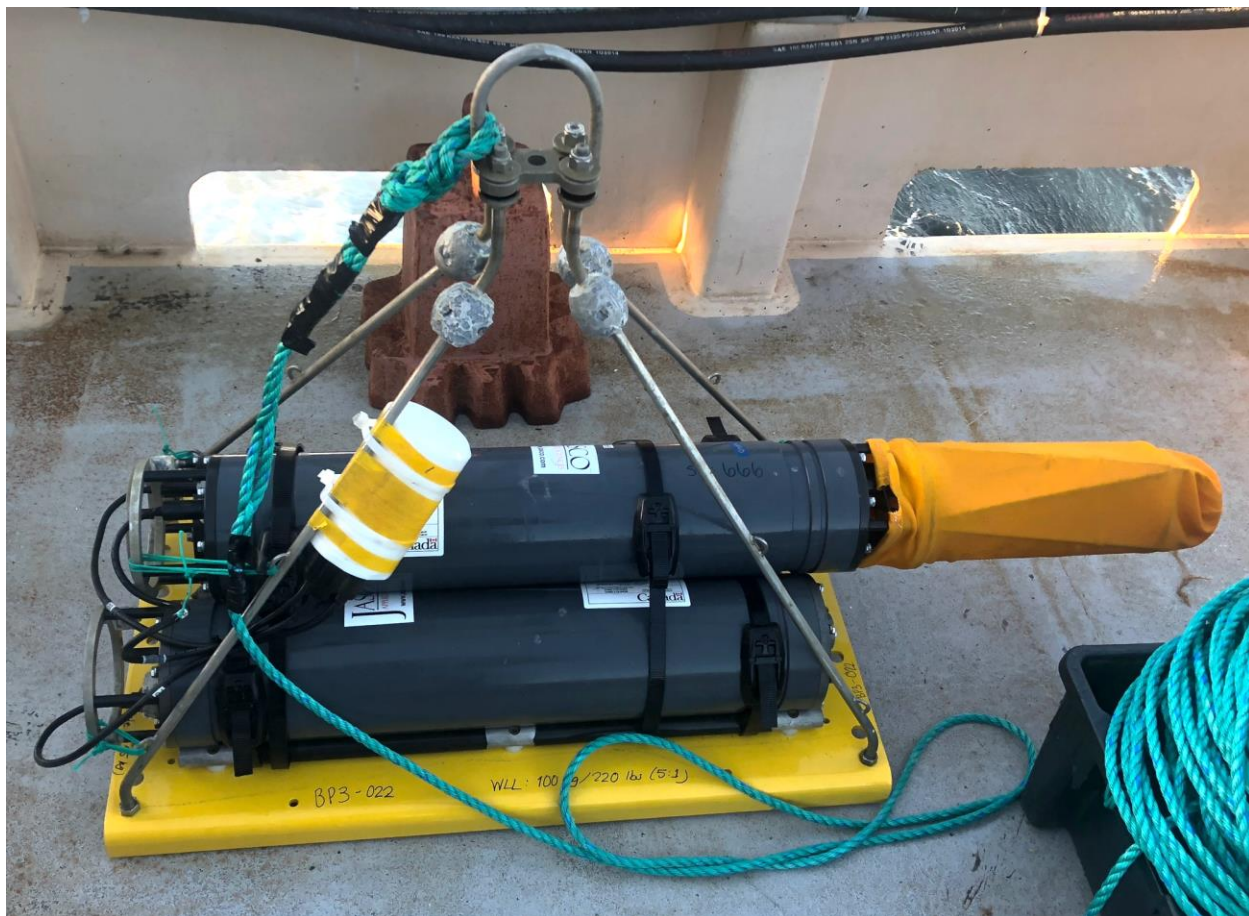
Figure 27. Ancrage d'un enregistreur acoustique autonome AMAR avant son déploiement sur le fond marin.
