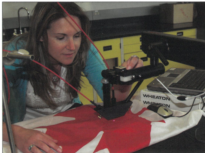
Figure 1. Judith Bannerman, boursière en recherche scientifique, utilise l'instrument de mesure de la micro-altération de la couleur pour examiner un drapeau du Canada en soie.
