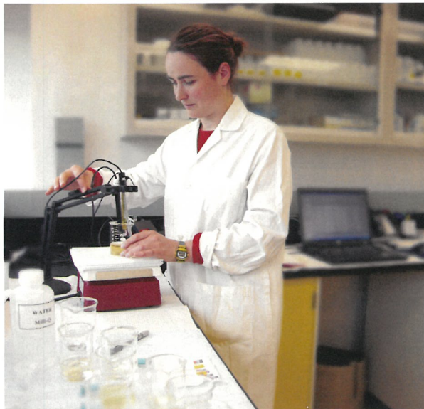
▲ Ute Werner, stagiaire (archéologie et objets) à l'ICC, mesure la concentration d'ions chlorure.
