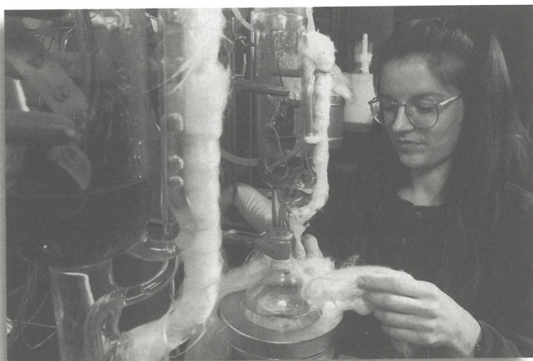
Nettoyage d'objet composite à l'aide du système Soxhlet.
