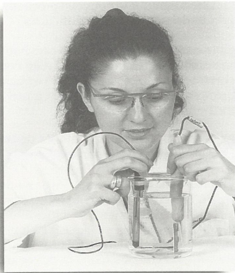
Mesure de la corrosion du fer.
