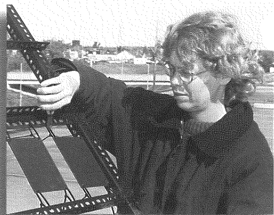
Nancy Binnie vérifie les échantillons d'acier rouillé du nouveau support à essais de l'ICC.
