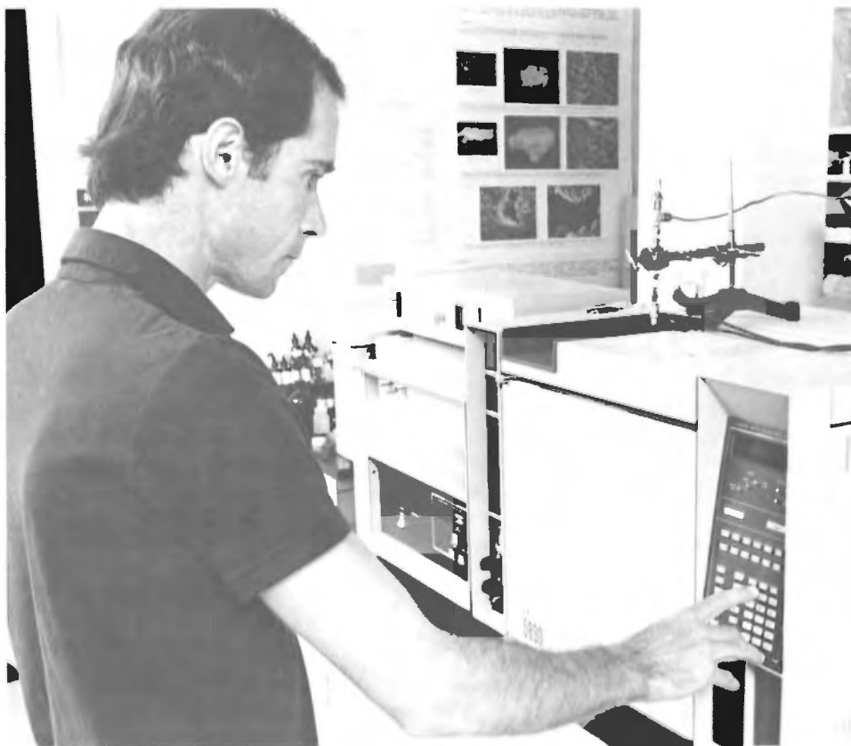
L'auteur utilise un chromatographe gazeux à discrimination de masse pour caractériser les émanations gazeuses.
