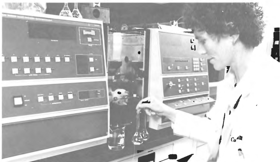
L'auteur a recours à la spectrophotométrie d'absorption atomique pour déterminer le profil d'éléments en trace lors de l'analyse d'un objet.
