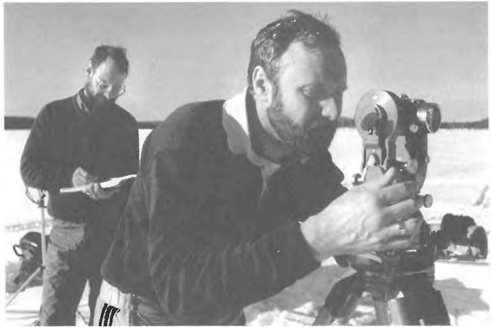
Tom Sawyer, de la Section des relevés des richesses du patrimoine, du Service canadien des parcs à Environnement Canada, utilise un théodolite pour établir des points de contrôle en vue de l'enregistrement photogrammétrique, pendant que l'auteur inscrit les mesures.
