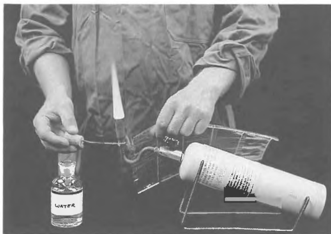
Figure 4. Le test Beilstein. Toucher avec un fil de cuivre chauffé au rouge un morceau du plastique soumis à l'essai. Placer le morceau de plastique de façon à ce que la fumée dégagée soit aspirée dans la prise d'air d'un brûleur au propane. Une flamme de coloration vert brillant indique que le plastique contient du chlore. Si la flamme conserve sa teinte bleutée, alors le plastique ne contient pas de chlore.
