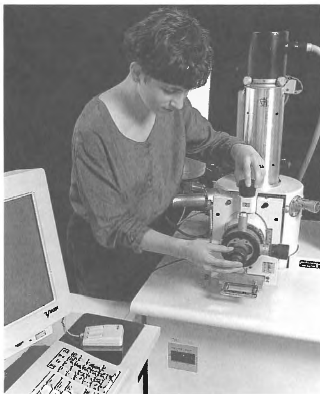
Figure 1. Kate Helwig introduit un échantillon dans le MEB en vue d'effectuer une micro-analyse aux rayons X.
