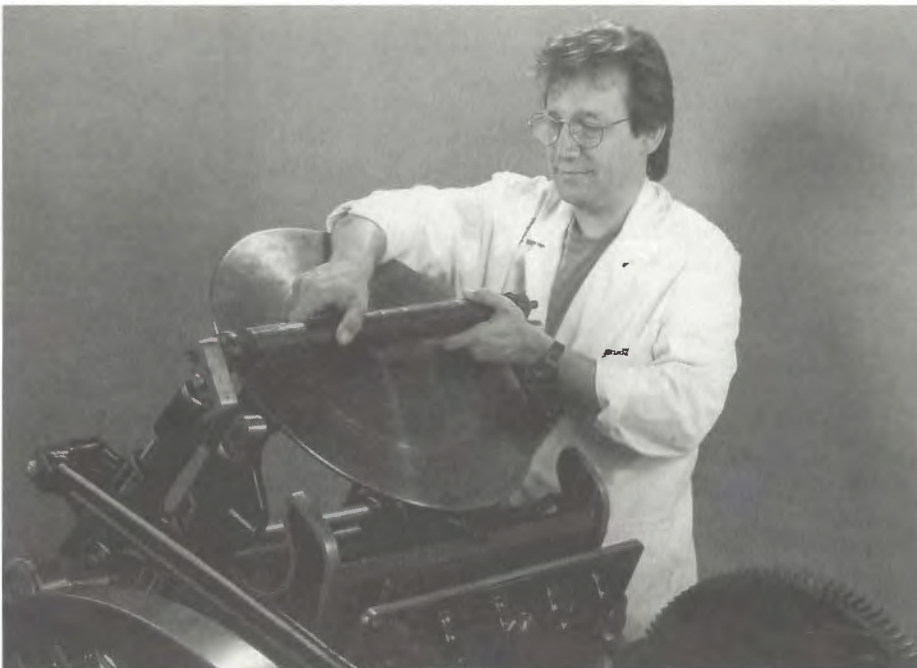
Installation du rouleau encreur original de la presse Chandler & Price
