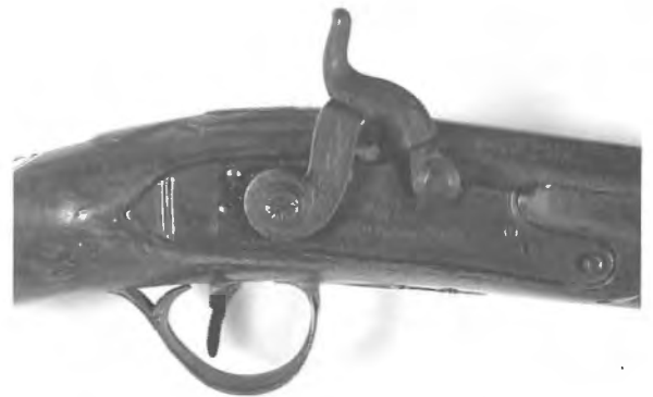
Vue latérale du mousquet du musée Lundy's Lane montrant la platine modifiée.
