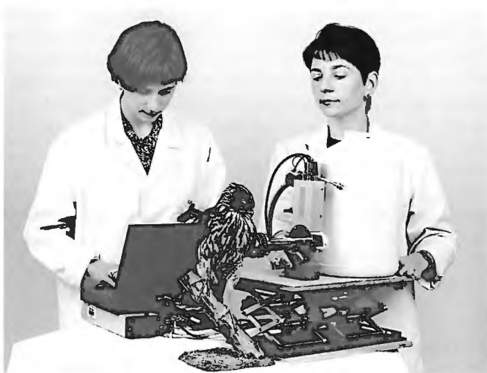
Figure 3. Spécimen d'histoire naturelle analysé à l'aide du spectromètre portatif.
