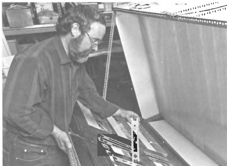
Malcolm Bilz dépose un échantillon de parylène mis à l'essai dans l'une des chambres sous lumière fluorescente de l'ICC.
