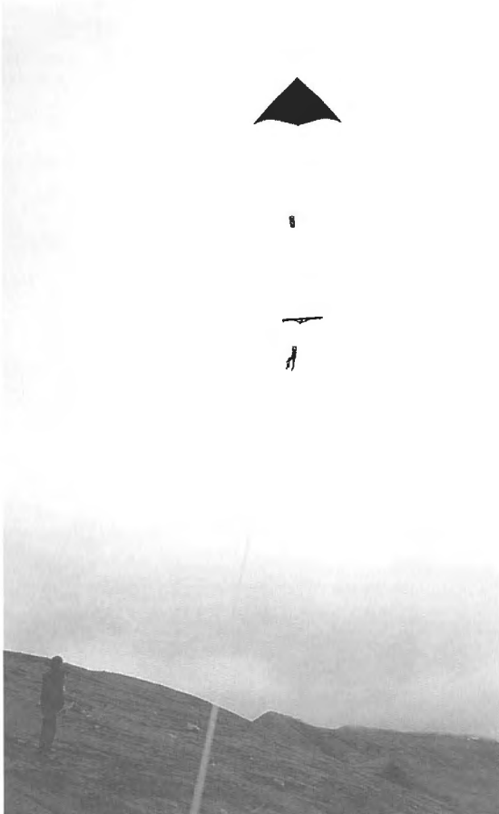
L'aile delta de 6 m et la nacelle contenant les deux appareils photo.
