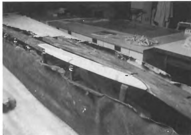
Remplacement d'une partie des serres de bouchain. Le kayak est sens dessus dessous; la toile de coton est dégagée pour révéler la peau de phoque.
