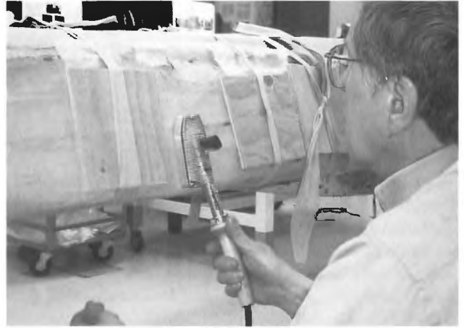
Tom Stone effectue le rentoilage de la vieille toile de coton sur la toile en acrylique.
