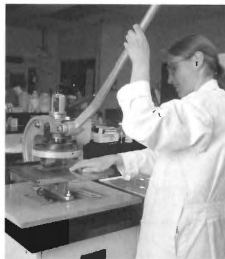
Irène Karsten coupe des échantillons d'adhésifs avant de mesurer leurs propriétés de déformation sous traction.
