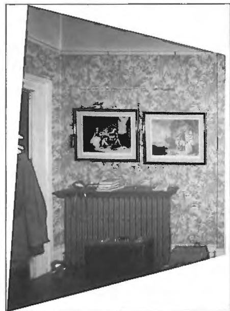
Photographie rectifiée. On voit maintenant le mur de face plutôt que sous un angle.
