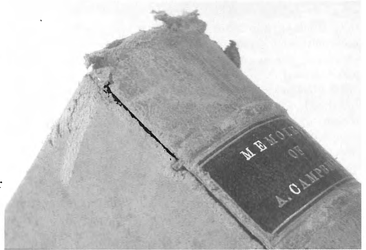
Détérioration (pourriture rouge) sur un livre relié en cuir de tannage végétal. Ce type de détérioration est causé par la transformation du dioxyde de soufre en acide dans le cuir. La surface acidifiée du cuir s'effrite et les couches asséchées du dessous laissent une poudre sur les doigts ou les surfaces.
