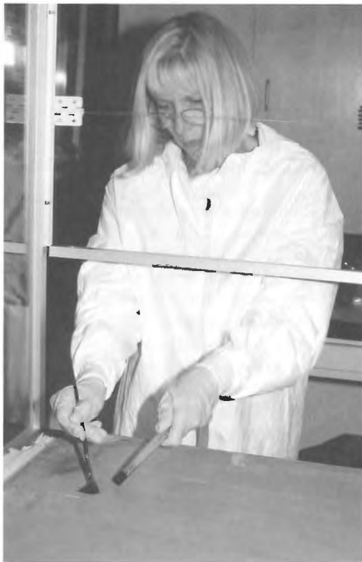
Restauratrice travaillant sous une enceinte de biosécurité de type 1. Observer que le bec de l'aspirateur est fixé à l'intérieur de la hotte, pour aider à prévenir tout contact accidentel avec l'objet à nettoyer et toute sortie du bec hors de l'enceinte.
