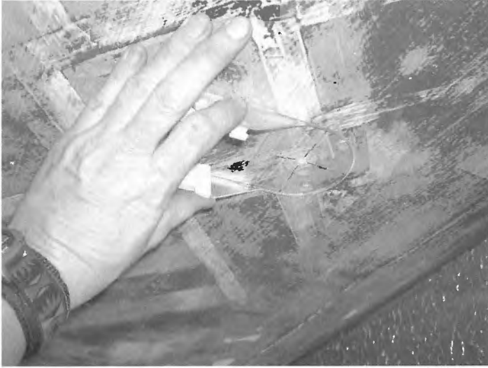
Motif au pochoir d'origine découvert sous l'un des 42 panneaux de plafond de l'entrée principale. La sonde de mesure du spectrophotomètre portable se trouve à l'endroit où la couleur sera mesurée.
