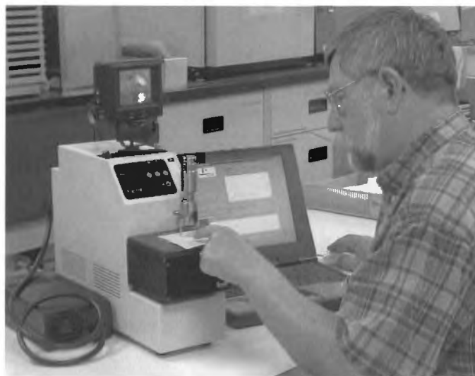
Figure 4. Utilisation du spectromètre TravelIR (Sensir Technologies) RTA à infrarouge. L'échantillon ou l'objet à analyser sont placés sur le cristal de l'enclume où Scott pointe le doigt.
