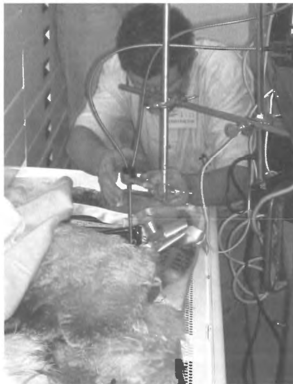
Figure 2. La sonde à fibres optiques du spectromètre peut être posée directement sur des objets fragiles comme ces échantillons en plumes. Ceci permet d'analyser les objets fragiles sans qu'ils soient manipulés, touchés ou sans qu'on y prélève des échantillons.
