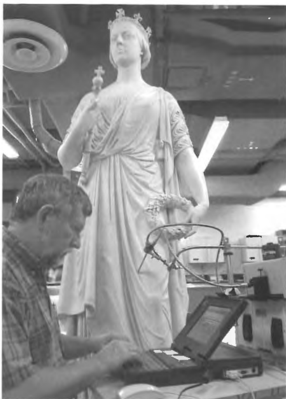
Figure 3. En consultant le spectre infrarouge après chaque étape du traitement, Scott peut surveiller les effets des solutions de nettoyage sur cette statue de la reine Victoria.
