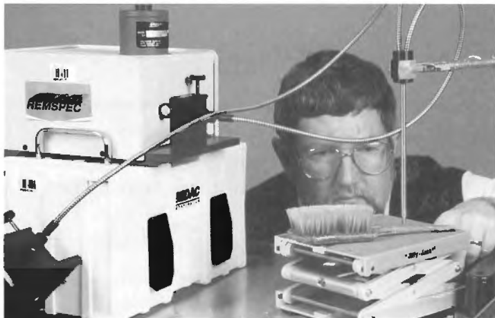
Figure 1. Scott Williams utilise le spectromètre à sonde à fibres optiques pour analyser les matériaux composant cette brosse.
