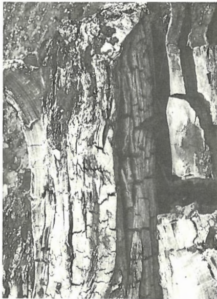
Rétrécissement et craquements d'un morceau de bois imbibé d'eau, causés par le séchage non contrôlé.
