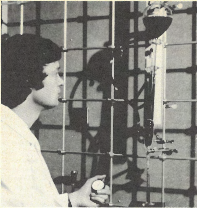
Pour tenter de rendre plus perméable le bois saturé d'eau, on a recours à des méthodes chimiques et biologiques. En effectuant des mesures à diverses pressions, un chercheur de la section de Recherche sur les méthodes de restauration de l'ICC évalue la vitesse avec laquelle un liquide peut traverser une pièce de bois traitée aux enzymes.
