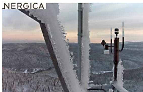
Figure 3.6 : Le capteur de surveillance de la glace IC-1 d'Icetek [87]
