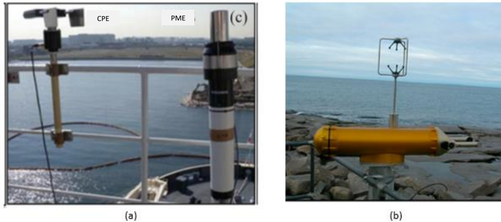
Figure 4.7 : (a) CPE (gauche) et PMES (droite) montés sur un navire [121], (b) CIP et l'anémomètre sonique [122]
