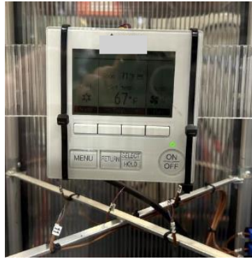
Figure 14. Thermostat communicant de l'unité C dans l'émulateur de l'environnement du thermostat
