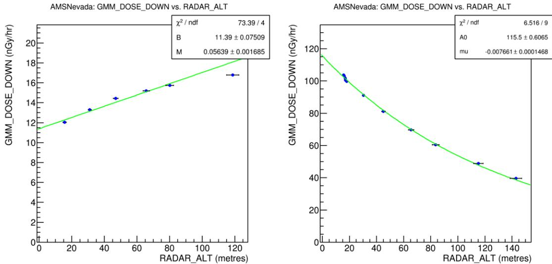
FIGURE 24 NRCAN RESULTS OF ALTITUDE SPIRAL OVER LAKE MOHAVE CALIBRATION RANGE. LEFT PLOT SHOWS DATA ACQUIRED OVER WATER, RIGHT PLOT DATA ACQUIRED OVER LAND. PLOTTED AS GC (LINEAR SCALE)
