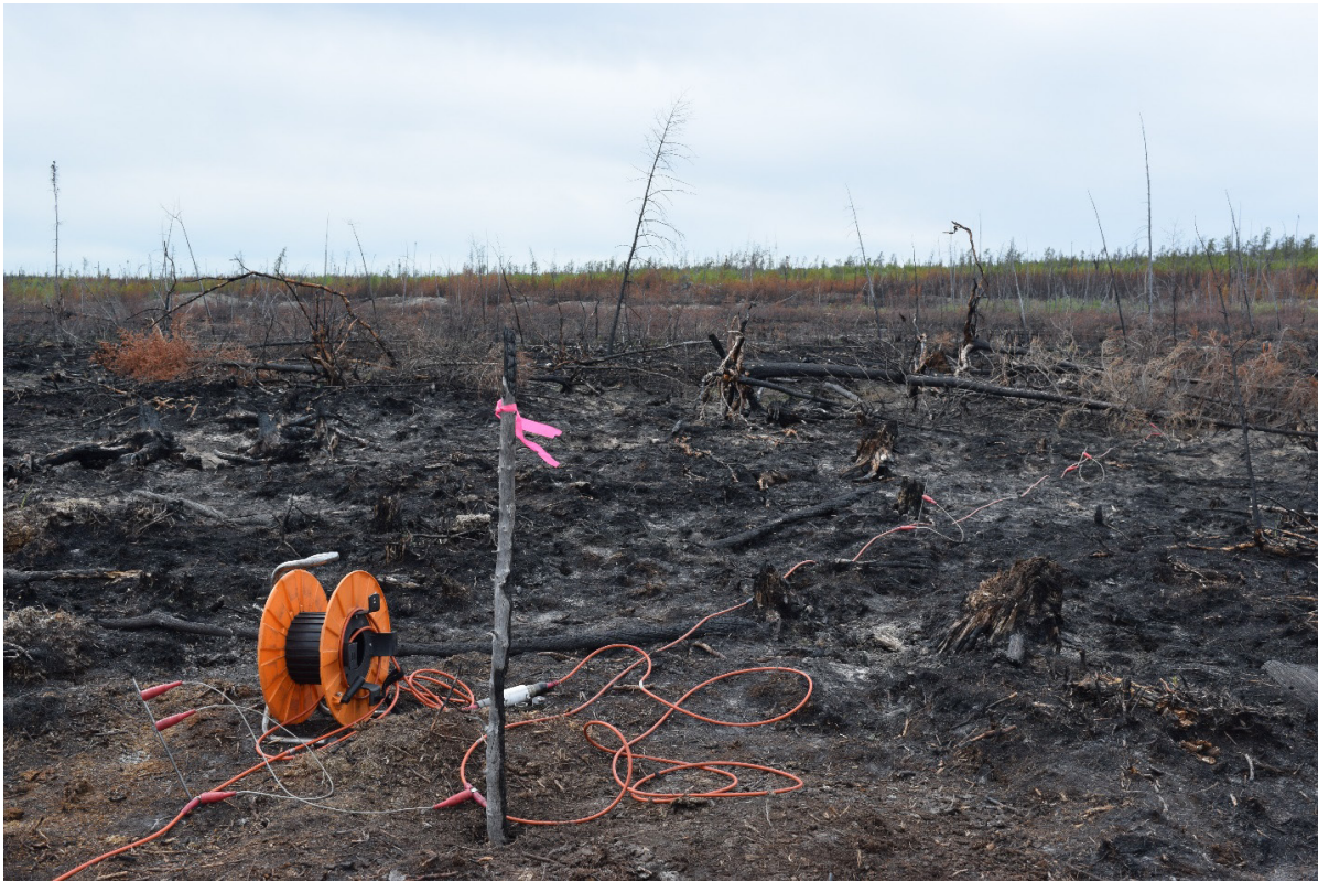
Figure 2. Électrodes et câbles utilisés dans un levé de tomographie par résistivité électrique mené en août 2016.
