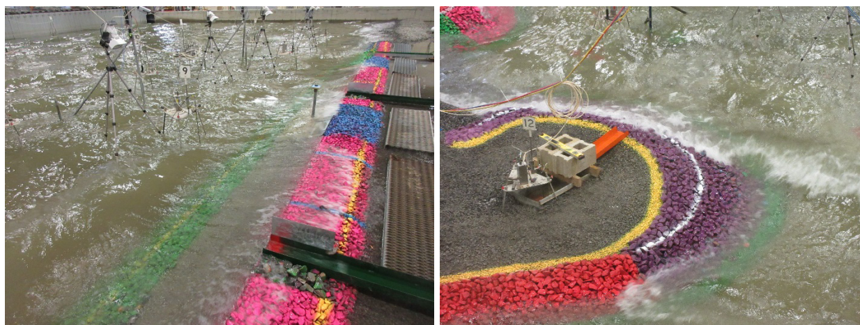
Figure 5.5. Des mesures de débordement des vagues sont effectuées dans des modèles physiques à l'échelle dans les laboratoires de Conseil national de recherches Canada, à Ottawa, afin de participer à la protection du littoral pour les sites côtiers canadiens.
