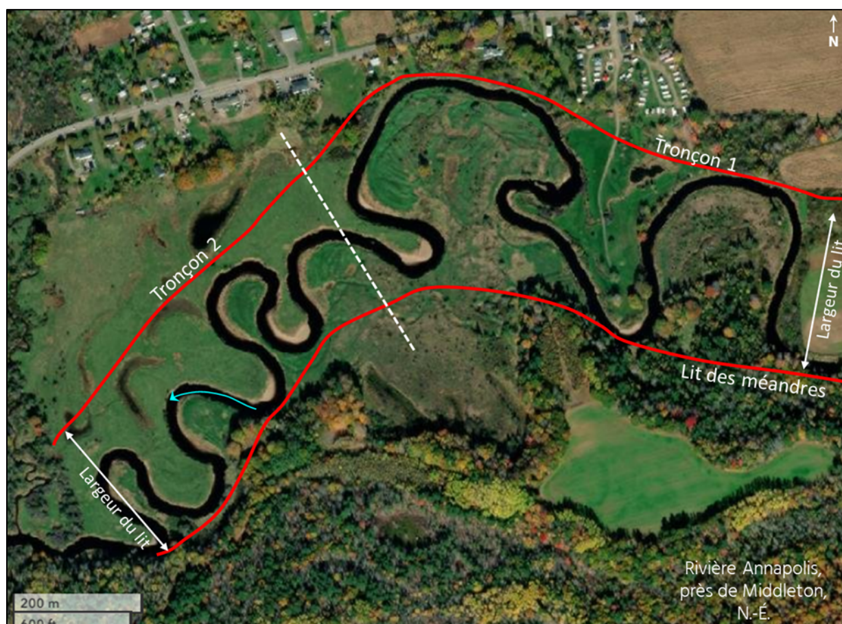
Figure 4.7. Exemple de lit des méandres sur la rivière Annapolis en Nouvelle-Écosse. La largeur du lit varie en fonction de l'amplitude des méandres, et le lit des méandres du tronçon 1 est plus large que celui du tronçon 2. Photo : Image satellitaire du monde ESRI, 12 octobre 2019.
