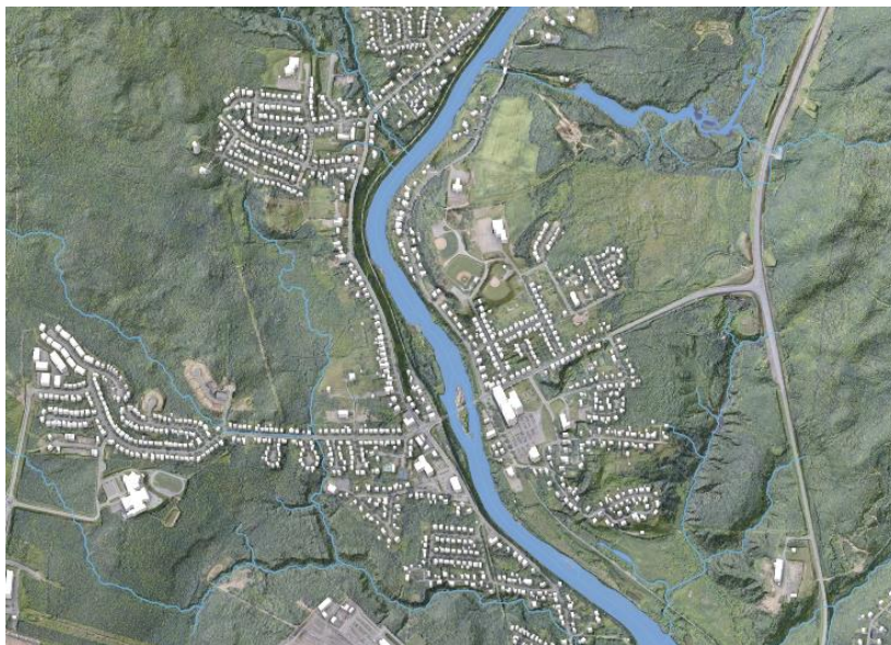
Figure 4. Diverses couches intégrées produites par RNCan à partir des données lidar de la SNDE, notamment le MNEHR (coloré avec des images satellite), les bâtiments extraits automatiquement et le Réseau hydrospatial canadien (RHC).
