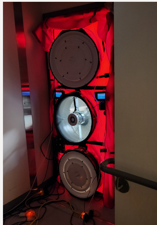
Figure 16: Blower door fan assembly using only one fan
