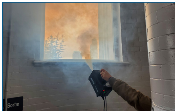
Figure 6 : Essai à la fumée
