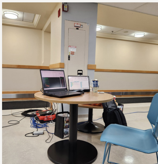
Figure 18 : Réseau câblé connecté à un ordinateur portable pour les essais d'étanchéité à l'air
