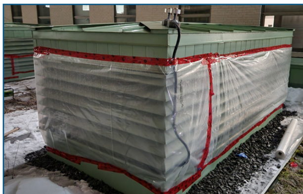
Figure 10 : Configuration des essais de l'enveloppe avec ventilation obturée
