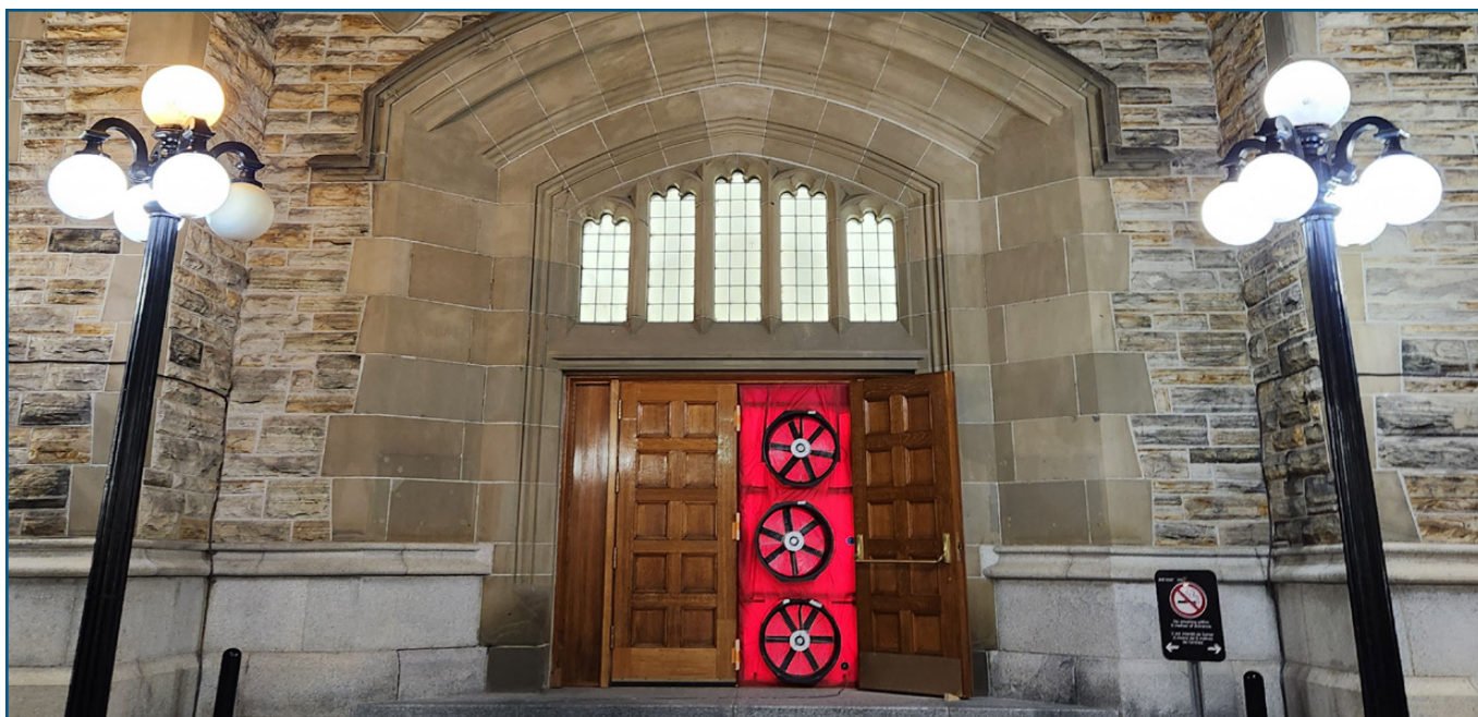
Figure 8 : Configuration de l'infiltromètre pour la pressurisation et la dépressurisation
