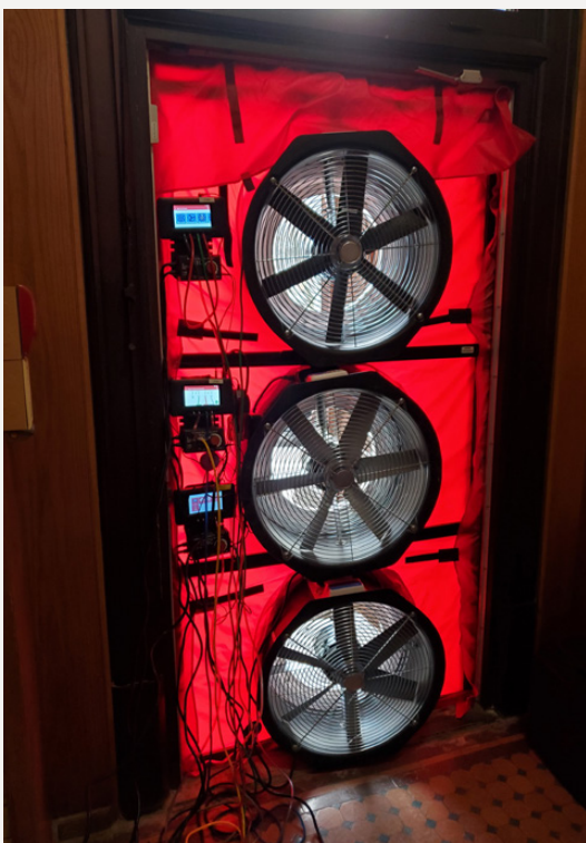
Figure 15 : Configuration des ventilateurs de l'infiltromètre
