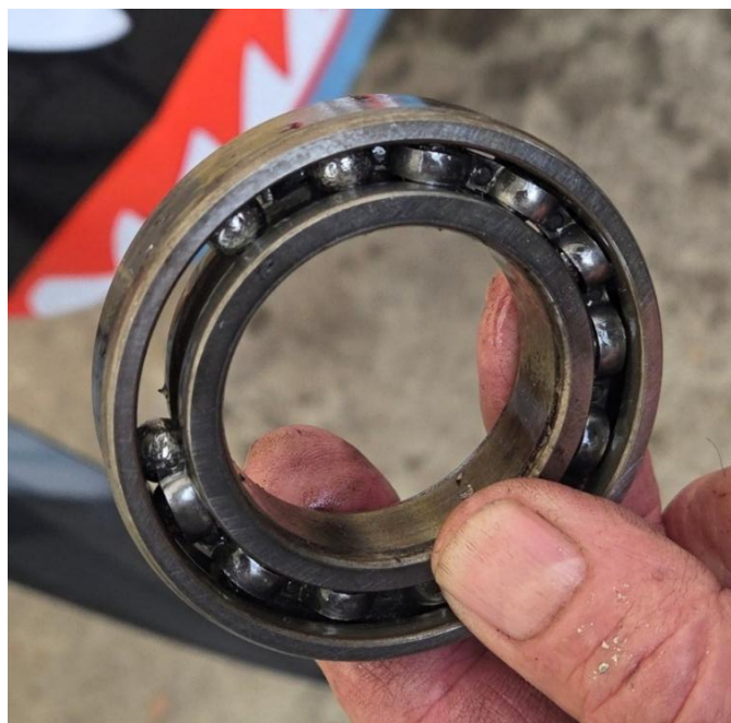
Image 3 : Roulement à rouleaux défectueux
