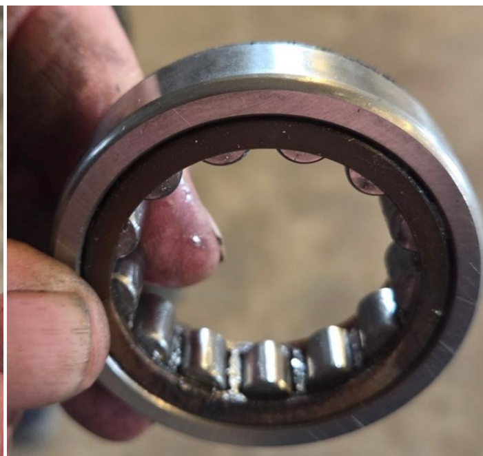
Image 4 : Limaille métallique (argent) sur un autre roulement de la boîte d'engrenages
