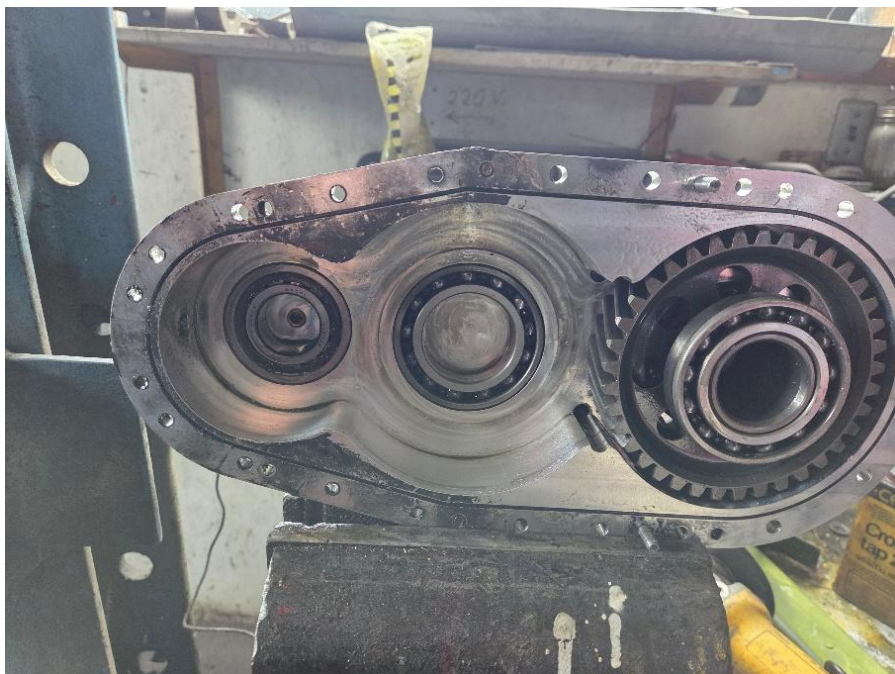
Image 1 : Boîte d'engrenages ouverte pour inspection
