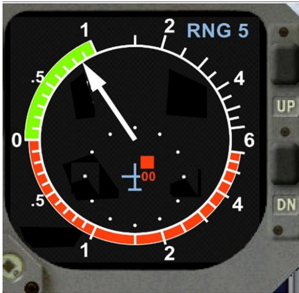
Figure 8 : En situation de dégagement, si le TCAS donne un avis de résolution en montée ou en descente qui contredit les instructions du contrôleur, on doit respecter ce RA mais exécuter la portion virage ordonnée par le contrôleur.
